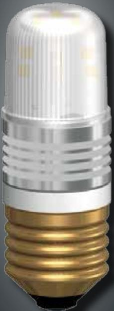
LED-Lampe mit Kühlkörper in AC/DC-Ausführung mit einer Leistung von ca. 2,3W. Durch die geringe Stromaufnahme ist diese Lampe ideal für den Einsatz in Notstrom-Anlagen geeignet. Die Helligkeit verhält sich analog der angelegten Spannung, sodass bei einem Spannungsabfall von 20% auch die Helligkeit nur um diesen Wert abnimmt.
