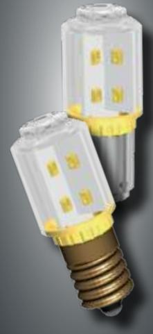
Notlicht LED-Lampe mit 16 Chip-LEDs, die segment-förmig im Abstand von 90° angeordnet sind. Homogene Lichtverteilung über 360° auf einer Länge von 20 mm. Schock- und vibrationsunempfindlich, geringste elektrische Leistung. Mindestspannung bis Leuchten erkennbar ca. 60V AC. Kombinierter 6-kant (SW10) und Kreuzschlitz für Schraubendreher an der Gehäuseoberseite zur Montageerleichterung.
