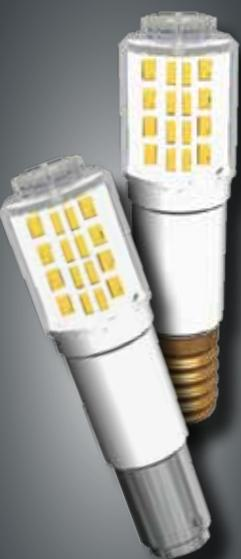
Notlicht LED-Lampe als Langversion mit 32 Chip-LEDs, die segment-förmig im Abstand von 90° angeordnet sind. Homogene Lichtverteilung über 360° auf einer Länge von 20 mm. Schock- und vibrationsunempfindlich, geringste elektrische Leistung. Mindestspannung bis Leuchten erkennbar ca. 120V AC / 150V DC Kombinierter 6-kant (SW10) und Kreuzschlitz für Schraubendreher an der Gehäuseoberseite zur Montageerleichterung.
